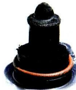
Фото 43 Грязь и смолистые отложения на рабочей части клапана
