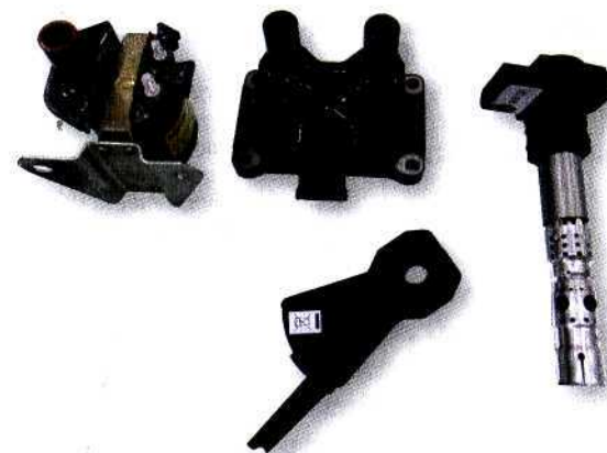
Фото 66 Внизу — триггерная цанга для синхронизации измерений. Вверху, слева направо — высоковольтная катушка, двухискровая и одноискровая (индивидуальная) катушки зажигания
