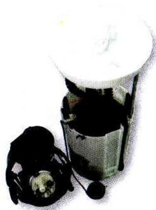
Пример компоновки погружного модуля с датчиком-потенциометром уровня топлива (поплавок) и регулятором топливоподачи (встроен в верхнюю часть модуля)
