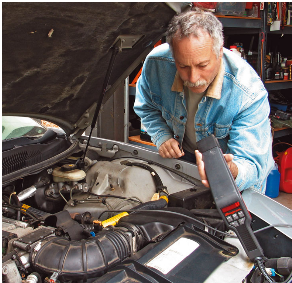
Индуктивный стробоскоп, прикрепленный проводом к катушке зажигания, покажет возможные сбои в работе
