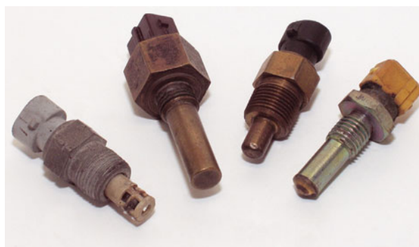
Датчик слева — температурный — наиболее прост в определении. Другие датчики тоже принадлежат к этому типу и произведены разными производителями
