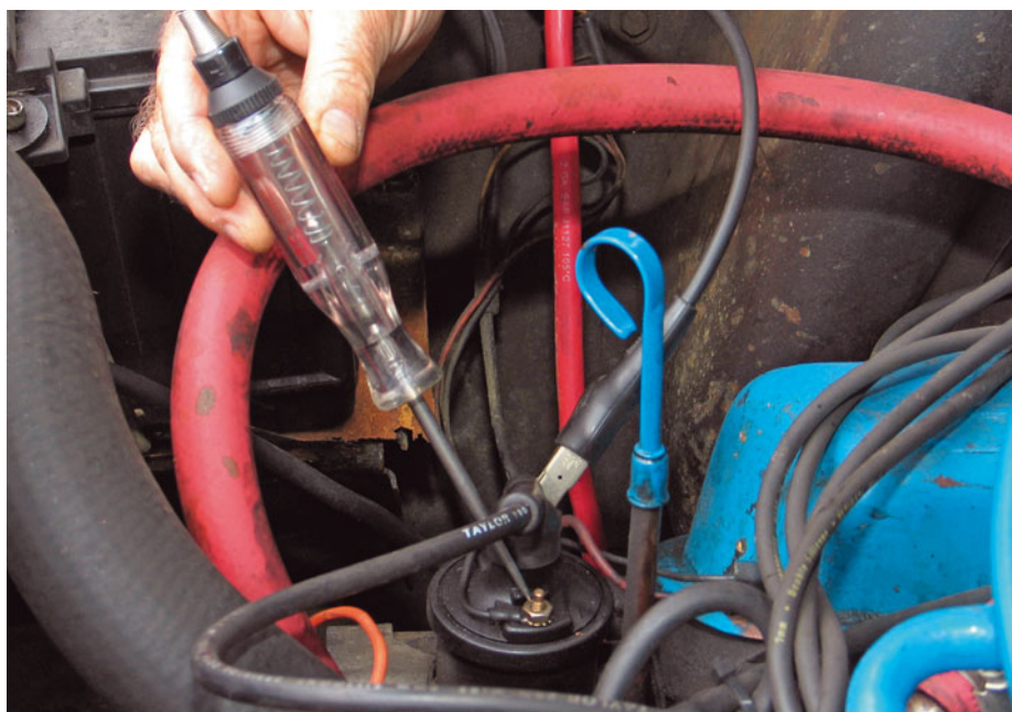
Контрольная лампочка: универсальный инструмент для тестирования переключений катушки зажигания
