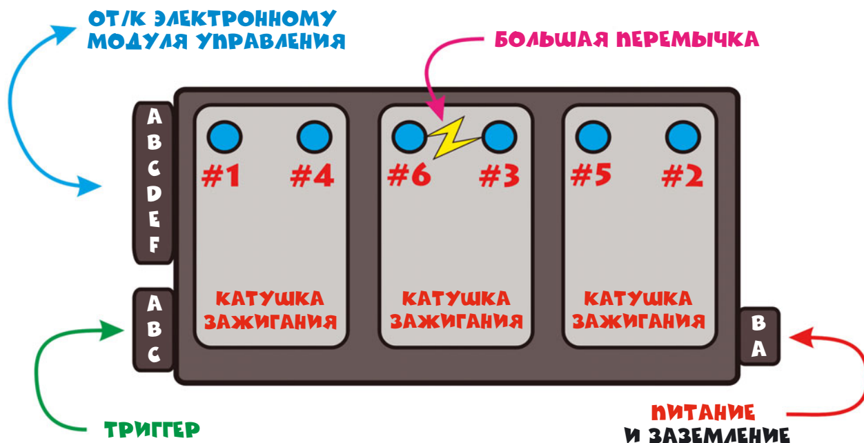
Рис. 6-10. Этот модуль и катушки используются в автомобилях GM на 2,8 и 3,1 литра. Поверните ключ зажигания в положение ON и, используя пробник («крокодил» пробника на положительной клемме аккумулятора), коснитесь щупом клемм А и С (контакты подсоединения датчика вала). Если модуль в порядке, между любой из трех пар выходных клемм катушки должна проявиться искра
