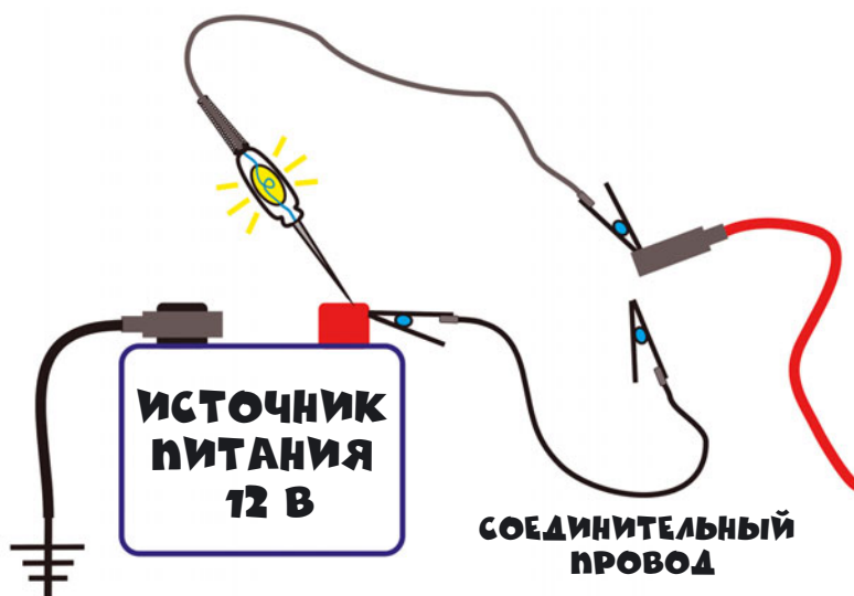
Рис. 9-10. На некоторых автомобилях управляемое компьютером реле может быть включено, в результате чего контрольная лампа загорится. Для устранения этой причины (как ложного показания пробником присутствия паразитарного тока) временно подсоедините провод-перемычку между положительной клеммой аккумулятора и батарейным кабелем, не отсоединяя при этом пробник
