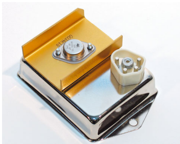
Этот модуль зажигания Chrysler использует большой транзистор, установленный в алюминиевом жаростойком корпусе золотого цвета (левый верхний модуль)
