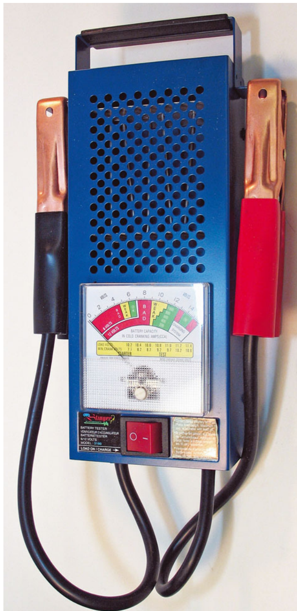
Тестер аккумулятора OTC 3180 Stinger позволяет нагружать батарею на 100 ампер. Карманные тестеры более удобны в использовании. Обе модели могут тестировать 6- и 12-вольтовые батареи
