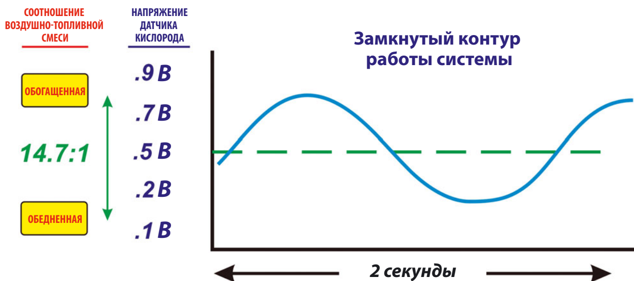
Рис. 7-5. Когда содержание кислорода в выхлопных газах низкое, разница содержания кислорода высока, и датчик выдает напряжение от 0,5 до 0,9 вольт. И наоборот, если датчик регистрирует высокое содержание кислорода (обедненная смесь) и, сравнивая его с наружным воздухом, получает меньшую разницу, то создается более низкое напряжение в пределах 0,1–0,4 вольт
